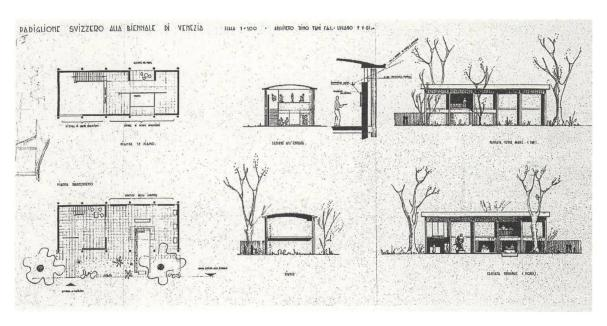
4 Rino Tami, Plan des Schweizer Pavillons für die «Biennale di Venezia», 2. Projekt, datiert auf den 9. Mai 1951 (Grundriss Erdgeschoss und 1. Stock; Schnitt durch den Eingangsbereich und Detailzeichnung der Beleuchtung; Aufrisse der Nord- und Südfassade)
