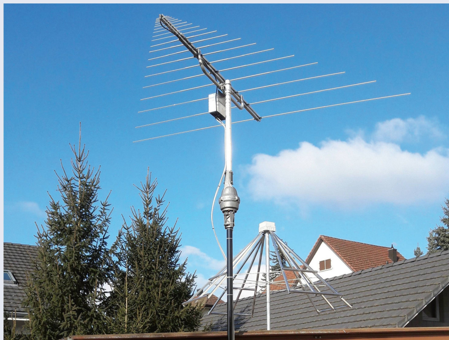
Abbildung 1: Mit der LPDA-Antenne (Vordergrund) wird die Sonne im Frequenzbereich von 150-870 MHz beobachtet. Die Antenne wird dabei der Sonne im Azimut nachgeführt. Die LWA-Antenne (Hintergrund) registriert die Radiobursts von der Sonne im Frequenzbereich 20-80 MHz. Der Frontend-Verstärker befindet sich übrigens im weissen Gehäuse oben auf der Antenne.
