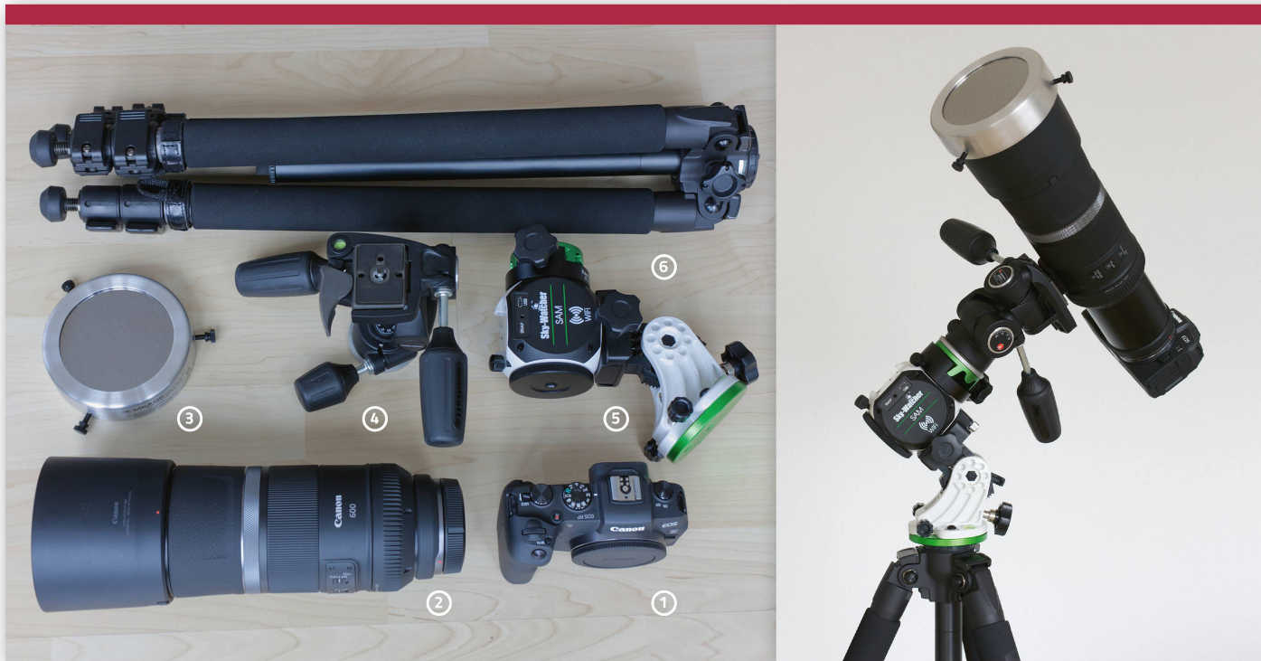
Abbildung 1: Das Sonnenfinsternis-Equipment: ① Kamera Canon EOS RP ② Objektiv Canon RF 600mm f11 ③ Glas Sonnenfilter von Meade ④ Stativkopf 3-Wege Neiger von Manfrotto ⑤ Nachführung Sky-Watcher Star Adventurer Mini ⑥ Kamerastativ Velbon Sherpa Pro
