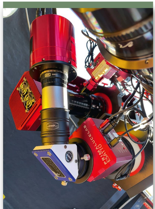
Abbildung 3: Esatto 2" Focuser von PrimaLuceLab mit B1800 Ca II K Diagonal von Lunt, Baader Fluorite Flatfield Converter und ZWO ASI 2600MM Pro CMOS-Kamera am Backend des NP-101 Refraktors von TeleVue.
