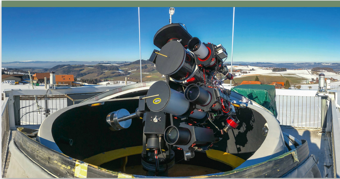
Abbildung 2: Instrumentenplattform in der 2.1 m Clamshell Kuppel von AstroHaven auf der Dachterrasse des Sonnenturm Uecht. Auf der GM3000 HPS Montierung von 10Micron sind zwei baugleiche NP-101 Refraktoren von TeleVue für die Sonnenbeobachtung sowie für die Nachtbeobachtung ein 132/925 mm Refraktor von William Optics, ein 80/352 mm Refraktor von Teleskop Service und ein 8 Zoll f/2.8 Astrograph von ASA montiert. Der Refraktor von William Optics ist mit einem Flip-Flat von Alnitak, die beiden anderen Nachtinstrumente mit Giotto Flatfield Generatoren bestückt. Die Steuerung der Komponenten erfolgt mittels vier Eagle Pro Computern, welche direkt auf den Instrumenten montiert sind.
