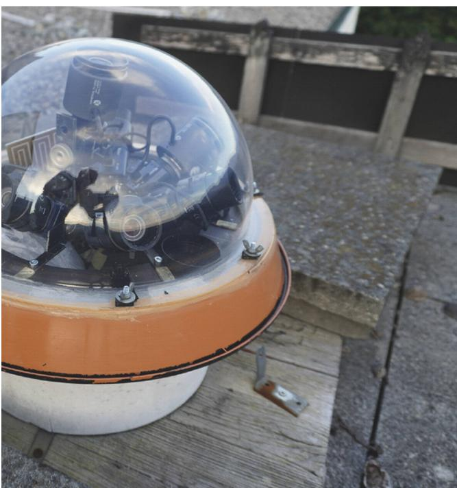
**Abbildung 1:** Ein trauriger Anblick! Die Videokameras der automatischen Meteorüberwachungsstation LOC hielten dem heftigen Hagelereignis am Abend des 25. August 2023 nicht stand. Sicher wird man eine Lösung finden, die für das Swiss Meteor Network wichtige Station wieder instand zu stellen.
