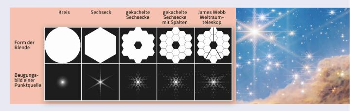
Abbildung 2 (links): Die Beugungsmuster von hellen Sternen in einem Teleskop werden durch die Form seiner Blende (Eintrittspupille) bestimmt. Diese Grafik erläutert, wie die achteckigen Beugungsmuster beim Webb-Weltraum-Teleskop im Detail zustande kommen. Eine starke Ausschnittvergrösserung eines Bildes vom Carina Nebel (NGC3324), aufgenommen mit dem Webb-Weltraum-Teleskop. Bei hellen Sternen sieht man typische, achteckige Beugungsmuster (rechts).
