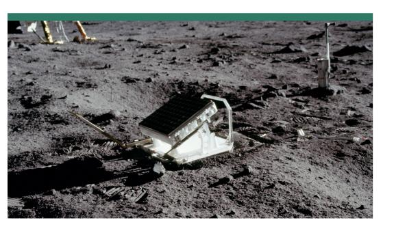
Abbildung 3: Dieser Retroreflektor wurde von Astronauten der Apollo-11-Mission auf dem Mond zurückgelassen. Astronomen auf der ganzen Welt haben Laserlicht von den Reflektoren reflektiert, um den Abstand zwischen Erde und Mond genau zu messen.
