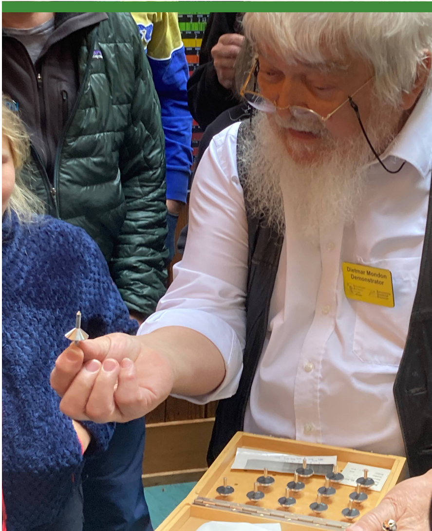
Abbildung 1: Dietmar Mondon präsentiert den geladenen Gästen das wertvolle hölzerne Kistchen mit den Kegelblenden für den Koronographen. Da die Sonne uns durch das Jahr infolge der unterschiedlichen Erdentfernung nicht immer gleich gross am Himmel erscheint, muss man je nach Jahreszeit einen etwas grösser oder kleiner durchmessenden Kegel einsetzen, um die helle Photosphäre der Sonne perfekt auszublenden.
