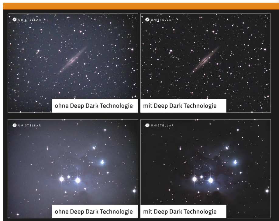
Abbildung 3: Der Bildvergleich zeigt, wie sich die Deep Dark Technologie dem Beobachter offenbart. Durch das Eliminieren der Himmelselligkeit wird der Kontrast der Objekte sichtbar besser.
