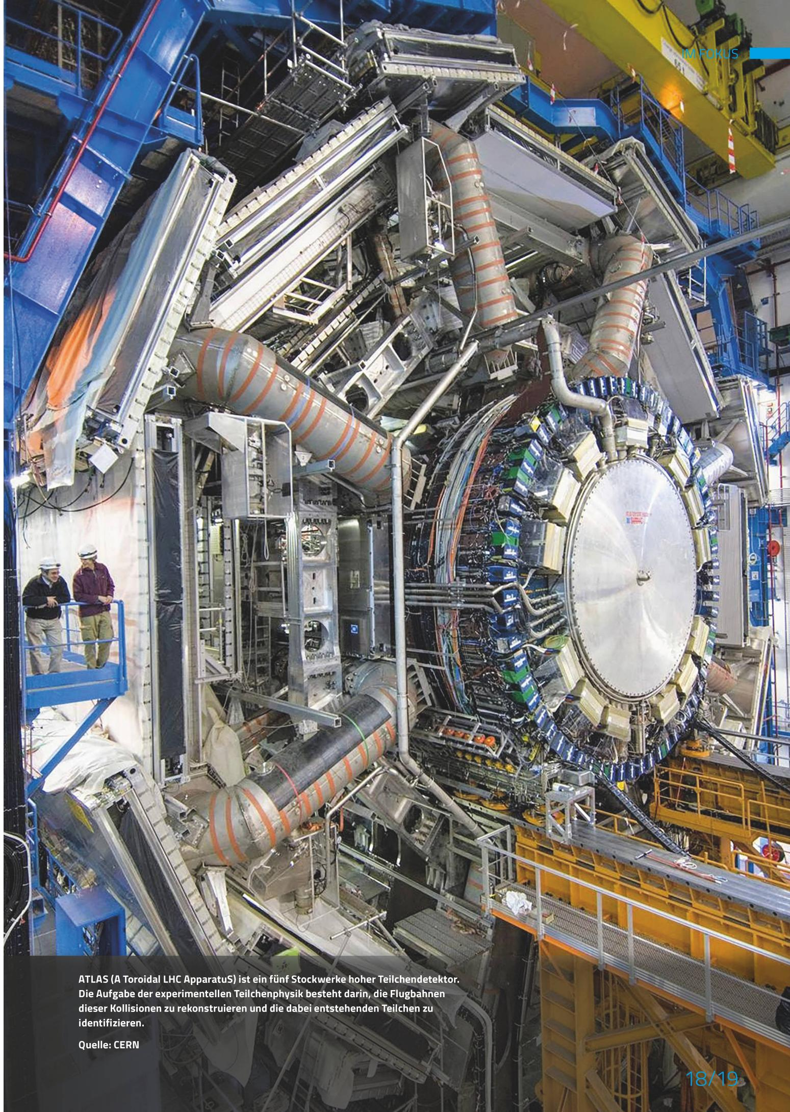
**ATLAS (A Toroidal LHC ApparatuS)** ist ein fünf Stockwerke hoher Teilchendetektor.
