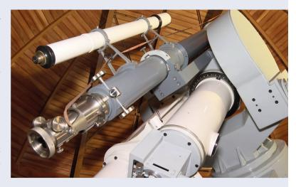
Abbildung 4: Innenansicht des alten Turmes mit dem Kern-Koronagraphen (grau) auf dem Zeiss-Koronagraphen (weiss) huckepack montiert.
