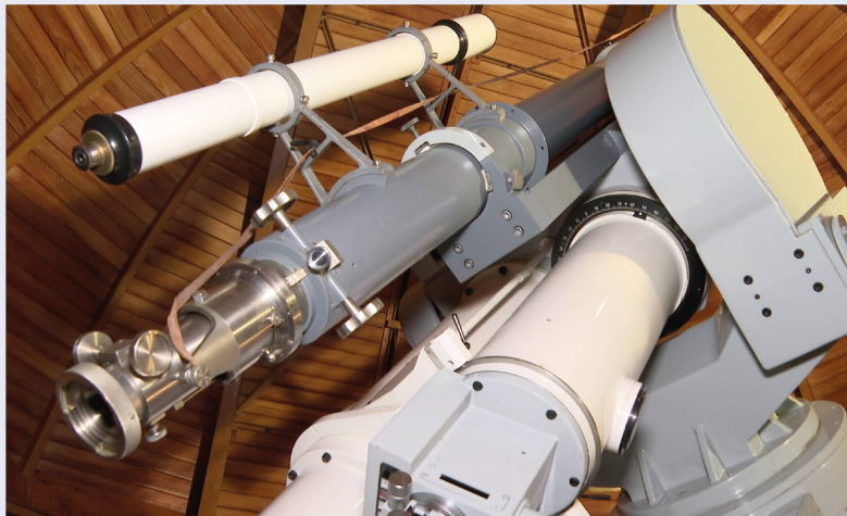
Abbildung 4: Innenansicht des alten Turmes mit dem Kern-Koronagraphen (grau) auf dem Zeiss-Koronagraphen (weiss) huckepack montiert.
