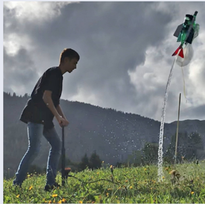
Abbildung 1: Start einer Wasser-Rakete mit integriertem Fallschirm-System aus einem Plastiksack.
