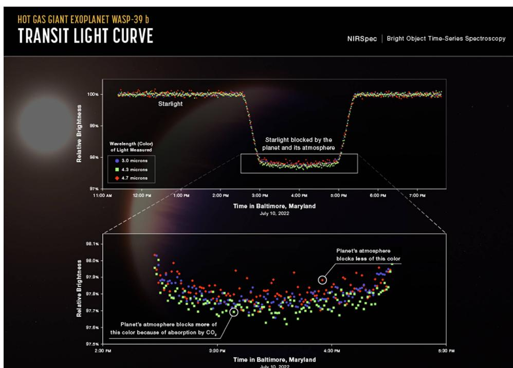
Eine Reihe von Lichtkurven von Webbs Nahinfrarot-Spektrograph (NIRSpec) zeigt die Helligkeitsänderung von drei verschiedenen Wellenlängen (Farben) des Lichts des WASP-39-Sternensystems im Laufe der Zeit, als der Planet am 10. Juli 2022 den Stern passierte. Ein Transit tritt auf, wenn sich ein umlaufender Planet zwischen dem Stern und dem Teleskop bewegt und einen Teil des Lichts vom Stern blockiert.
