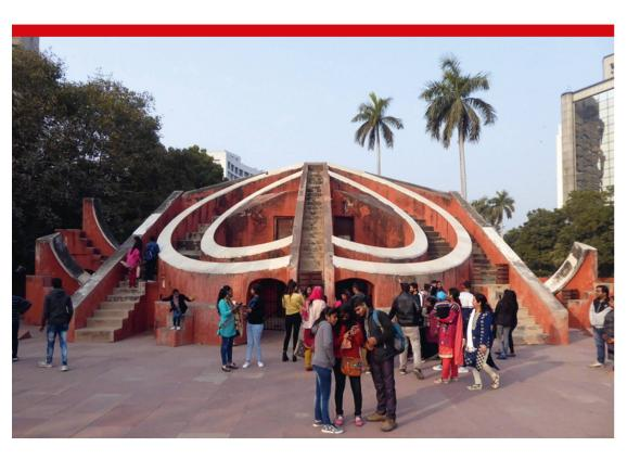
Abbildung 6: Das Misra Yantra in Delhi ist eine Kombination von fünf verschiedenen Instrumenten. Der innere Bogen auf der rechten (östlichen) Seite zeigt die Kulmination der Sterne auf dem Meridian von Zürich an.
