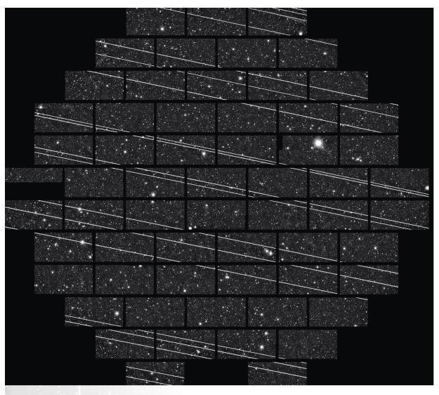
19 Starlink-Satelliten stören eine Aufnahme des Himmels, die 5.5 Minuten lang belichtet wurde. Quelle: NSF's National Optical-Infrared Astronomy Research Laboratory/CTIO/AURA/DELVE
