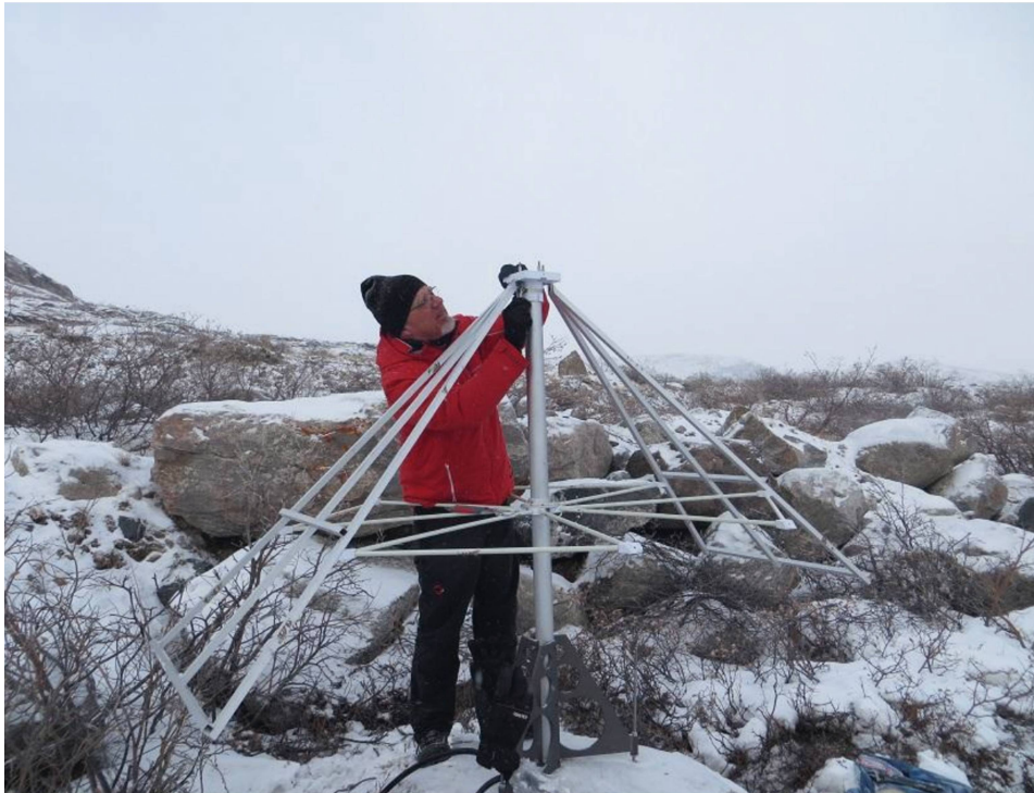
LWA-Antenne, montiert auf einem Felsen in Grönland. Rentiere sollen die Antenne nicht als Kratzbürste missbrauchen. Die Gewindestangen zur Befestigung der Montierung wurden mit speziellem, kältetauglichem Kleber in vorgebohrte Löcher im Felsen eingeklebt. Bei -20^{\circ}\text{C} war die Bastelei an der Antenne für Christian Monstein gewöhnungsbedürftig und nicht trivial.
