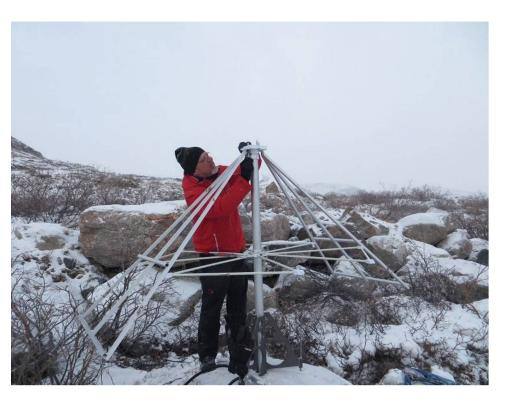
LWA-Antenne, montiert auf einem Felsen in Grönland. Rentiere sollen die Antenne nicht als Kratzbürste missbrauchen. Die Gewindestangen zur Befestigung der Montierung wurden mit speziellem, kältetauglichem Kleber in vorgebohrte Löcher im Felsen eingeklebt. Bei –20°C war die Bastelei an der Antenne für Christian Monstein gewöhnungsbedürftig und nicht trivial.
