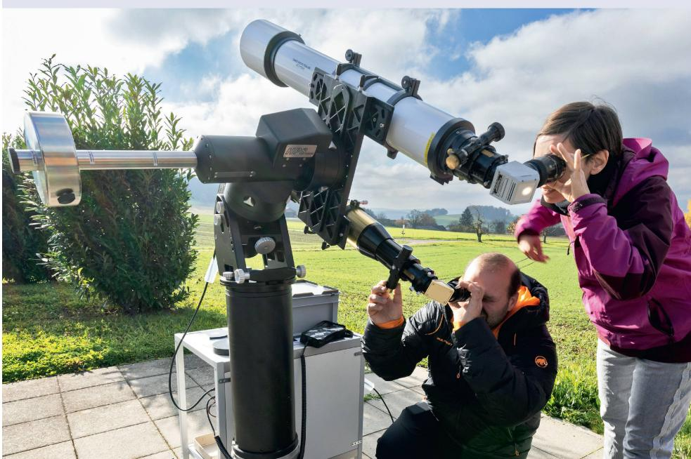
**Abbildung 1:** Beobachtung der Sonne mit den mobilen Aussenteleskopen mit H-alpha-Filter und Herschel-prisma für Weisslicht anlässlich eines Demonstratoren-Workshops.
