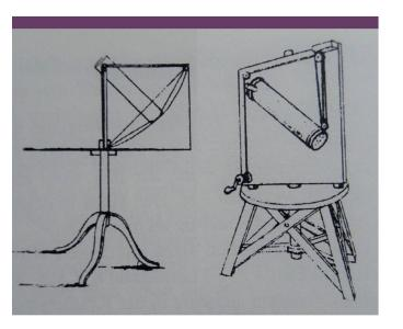
Abbildung 3: Die beiden Newton-Teleskope, mit denen Caroline acht Kometen entdeckte, waren unglaublich primitiv: Das grössere Instrument (rechts) hatte einen 10 cm-Spiegel mit einer Tubuslänge von 1.5 Metern. Die wegen einer Typhus-Erkrankung in ihrer Jugend nur 1.47 m kleine Caroline musste an diesem Instrument stets einen mehrstufigen Tritt benutzen.
