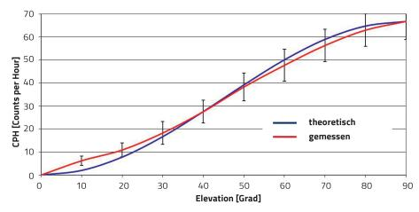
Abbildung 5: Zählrate der Myonen in Funktion des Elevationswinkels (90° − ⊖). Der theoretische Wert wurde bei einer Elevation von 90 Grad gleichgesetzt mit dem gemessenen Wert. Somit kann schön aufgezeigt werden, dass die Absorption in der Atmosphäre recht genau dem Cosinus im Quadrat gehorcht. (Grafik: Peter Hirt)
