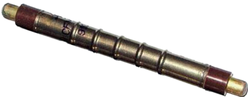
Abbildung 3: Geiger-Müller-Zählrohr SBM-20 aus früherer sowjetischer Produktion.
