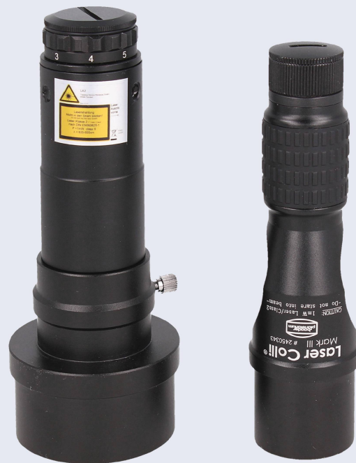
Beispiel eines in der Schweiz erhältlichen korrekt beschrifteten Laserkollimators.
