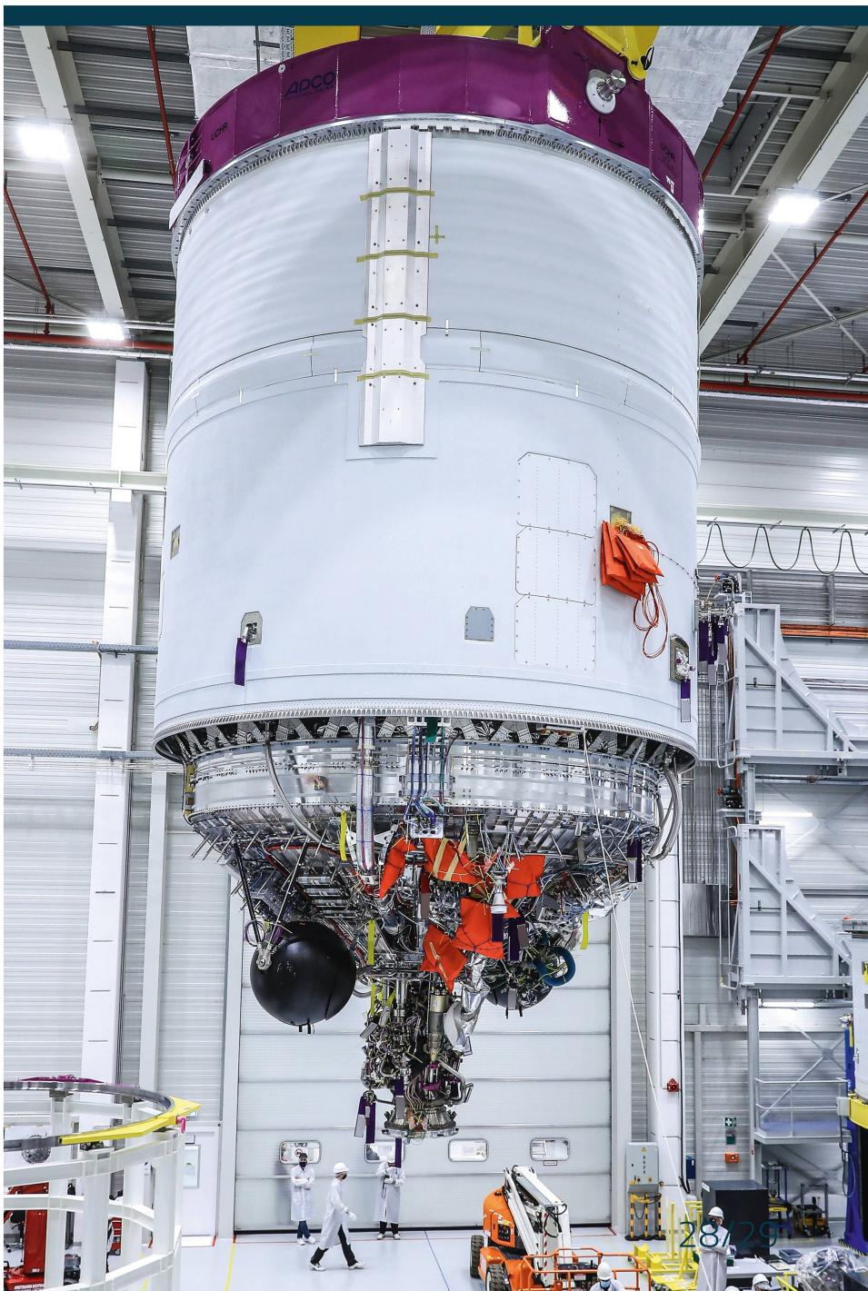
**Bild: Von eindrücklicher Grösse: Das Hot Firing Model (HFM) – ein Testmodell der gesamten Oberstufe – wurde letztes Jahr bei ArianeGroup in Bremen zusammengebaut, hat bereits umfassende funktionelle Tests durchlaufen und ist einsatzbereit. Das neue, wieder-zündbare Vinci-Triebwerk ist mit zwei Flüssigwasserstoff- und Sauerstofftanks verbunden und mit allen Leitungen, Ventilen sowie elektronischen und hydraulischen Leit- und Steuersystemen ausgestattet.**
