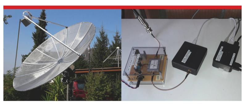
Bild: Parabolantenne (D1m9) mit einem Durchmesser von 1.9 Meter und mit einem Horn – einem ausgedienten Milchkesseli – abgestimmt auf die Frequenz des neutralen Wasserstoffs bei 1420 MHz. Direkt am Horn ist auch der Frontend-Verstärker (Nooelec SAWbird) montiert. Damit möglichst wenig Störungen eingekoppelt werden, ist es wichtig, dieser Frontend-Verstärker so nahe wie möglich am Dipol anzuordnen.
