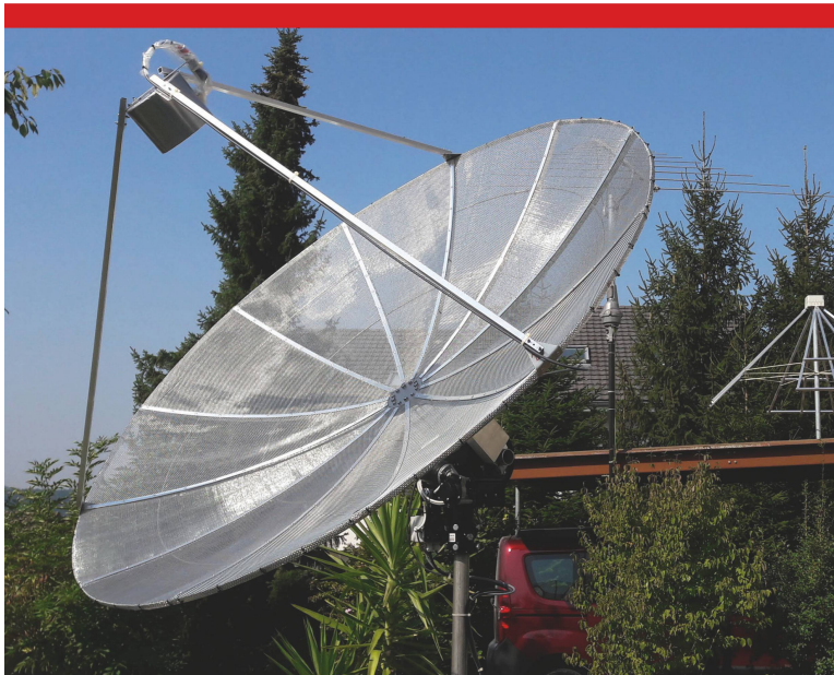
Bild: Parabolantenne (D1m9) mit einem Durchmesser von 1.9 Meter und mit einem Horn – einem ausgedienten Milchsesseli – abgestimmt auf die Frequenz des neutralen Wasserstoffs bei 1420 MHz. Direkt am Horn ist auch der Frontend-Verstärker (Nooelec SAWbird) montiert. Damit möglichst wenig Störungen eingekoppelt werden, ist es wichtig, dieser Frontend-Verstärker so nahe wie möglich am Dipol anzuordnen.
