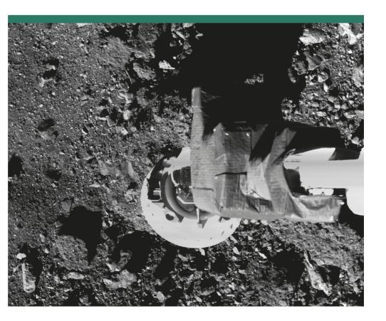
Abbildung 3: Hier sammelt die Raumsonde OSIRIS-REx Gesteinsproben des Asteroiden 101955 Bennu ein.
