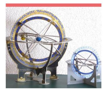
Abbildung 7: Das kleine und das grosse Tisch-Planetarium von AstroMedia. Das grosse Modell enthält – von aussen nach innen – fest stehend den Horizont (waagrecht), senkrecht dazu den Meridianring (für alle geogr. Breiten einstellbar); um die Himmelsachse drehbar zwei Ringe der Himmelskugel, darin die 23.5° schief liegende Ekliptik mit der Mondbahn, deren Knoten verschiebbar sind. Sonne, Mond und Planeten aus geschlitzten Moosgummikugeln können an passender Stelle auf die Ringe gesteckt werden.
