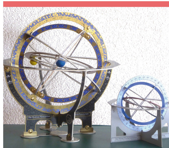
Abbildung 7: Das kleine und das grosse Tisch-Planetarium von AstroMedia. Das grosse Modell enthält – von aussen nach innen – fest stehend den Horizont (waagrecht), senkrecht dazu den Meridianring (für alle geogr. Breiten einstellbar); um die Himmelsachse drehbar zwei Ringe der Himmelkugel, darin die 23.5^\circ schief liegende Ekliptik mit der Mondbahn, deren Knoten verschiebbar sind. Sonne, Mond und Planeten aus geschlitzten Moosgummikugeln können an passender Stelle auf die Ringe gesteckt werden.
