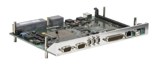
**Abbildung 2:** Der neue Lynx-Computer ist 250-mal leistungsstärker als normale Bordcomputer. Die Entwicklung wurde mit Hilfe eines Vertrags aus dem Programm der Europäischen Weltraumorganisation für fortgeschrittene Forschung in Telekommunikationssystemen (ARTES) erreicht und bei RUAG Space in Göteborg, Schweden, durchgeführt.
