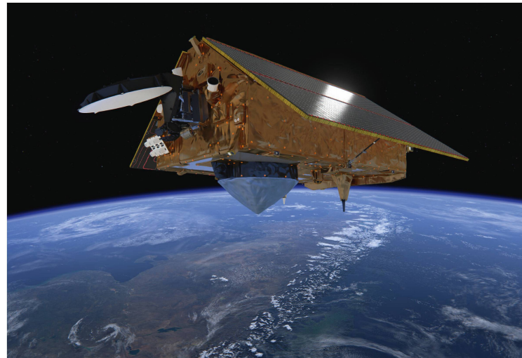
Abbildung 1: Copernicus Sentinel-6 über den Anden. Der Satellit übernimmt die Rolle der Radaraltimetrie-Referenzmission und setzt die Langzeitaufzeichnung von Messungen der Meeresoberflächenhöhe fort, um den Anstieg des Meeresspiegels zu überwachen und Wissenschaftlern zu helfen, den Eisverlust an den Polen, an Gletschern und am Meer besser zu verstehen.
