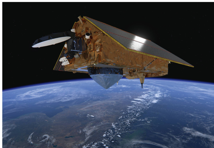
Abbildung 1: Copernicus Sentinel-6 über den Anden. Der Satellit übernimmt die Rolle der Radaraltimetrie-Referenzmission und setzt die Langzeitaufzeichnung von Messungen der Meeresoberflächenhöhe fort, um den Anstieg des Meeresspiegels zu überwachen und Wissenschaftlern zu helfen, den Eisverlust an den Polen, an Gletschern und am Meer besser zu verstehen.
