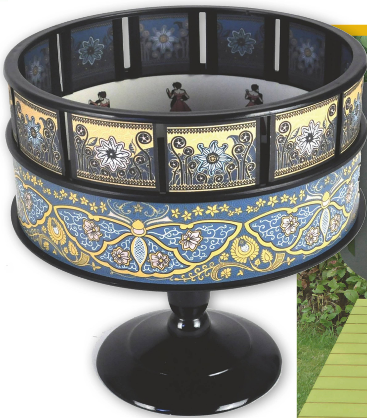
Abbildung 6: Diese Maschine mit dem Namen Zoetrope oder auch Wundertrommel erzeugte u. a. die ersten bewegten Bilder. Man blickt bei drehendem Zylinder durch die vorbeisauenden Sehschlitze und sieht so für einen kurzen Augenblick jeweils die gegenüberstehenden Bilder – bei jedem nächsten Schlitz das nächste Bild. So entsteht ein bewegtes Bild, das sich nach jeder Umdrehung wiederholt.
