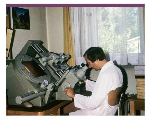
**Abbildung 3:** Freimut Börngen sucht hier in den 1970er-Jahren am Zeiss-Blinkkomparator nach Asteroiden-Spuren.
