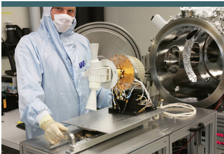
Abbildung 2: Das Massenspektrometer STROFIO vor dem Einbau in die Eichkammer am Physikalischen Institut der Universität Bern.
