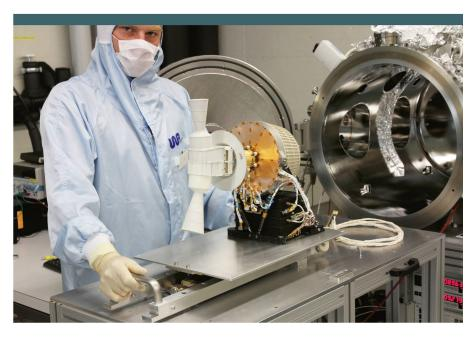
**Abbildung 2:** Das Massenspektrometer STROFIO vor dem Einbau in die Eichkammer am Physikalischen Institut der Universität Bern.
