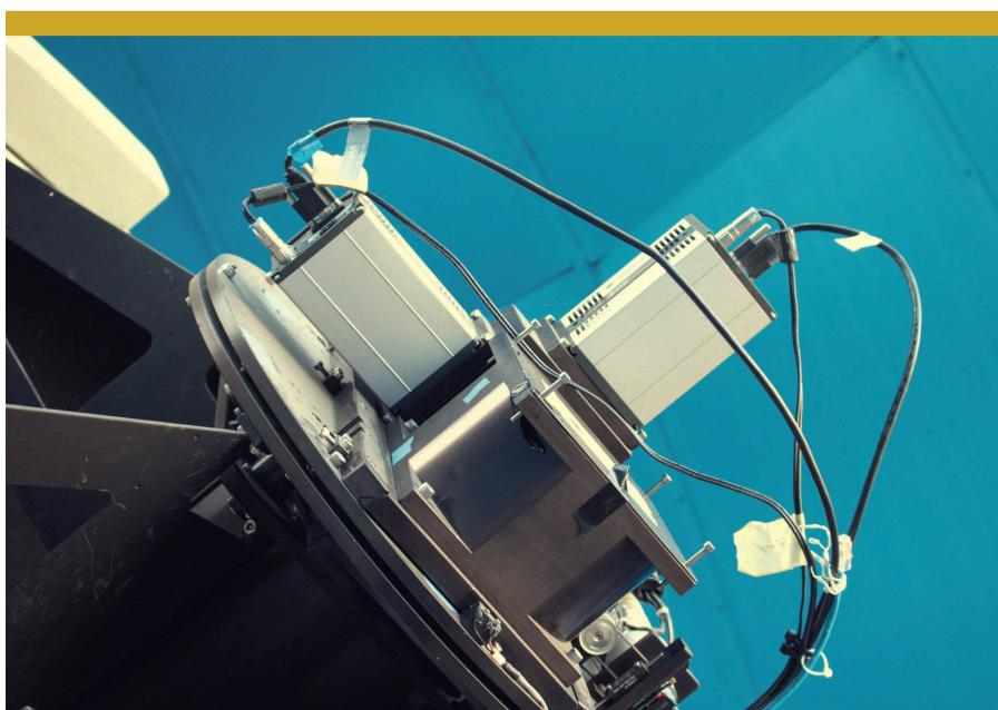
**Abbildung 5:** Zwei moderne, hochempfindliche sCMOS-Kameras sind im Primärfokus des Reflektors angebracht und registrieren die Mondbilder synchron bei unterschiedlichen Wellenlängen, nämlich im R- und I-Band. Da das vom Hauptspiegel kommende Licht über einen dichroitischen Strahlteiler an die beiden Kameras weitergeleitet wird, sind diese zueinander rechtwinklig angeordnet.
