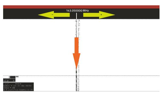
Figure 5: Les signaux sont représentés sur un modèle de type Waterfall. Le décalage en fréquence Δf se mesure en abscisse (flèches jaunes) et le temps s'écoule en ordonnée (flèche orange).
