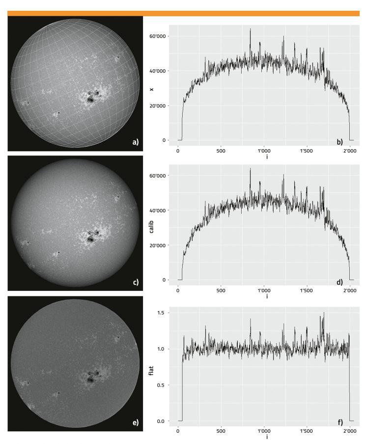
**Abbildungen 4a (oben links) – 4f (unten rechts):** Eingelesenes und mit Gradnetz versehenes, kalibriertes und standardisiertes Sonnenbild sowie dazugehörige horizontale Schnitte durch das Zentrum der sichtbaren Sonnenscheibe.
