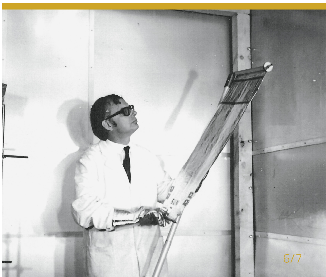
Abbildung 1: Johannes Geiss testet 1971 in der Klimakammer der Contraves in Zürich das Funktionieren des für Apollo 16 modifizierten Sonnenwindsegels.
