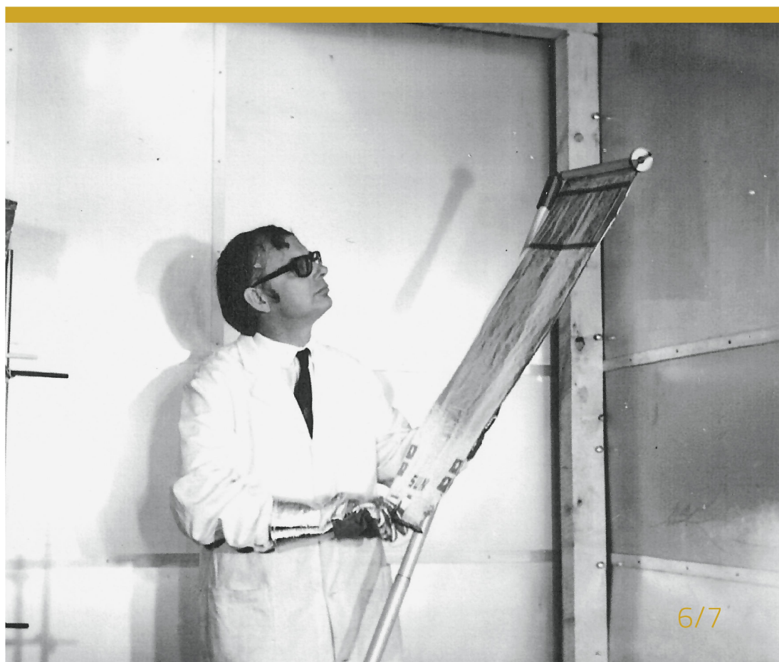
Abbildung 1: Johannes Geiss testet 1971 in der Klimakammer der Contraves in Zürich das Funktionieren des für Apollo 16 modifizierten Sonnenwindsegels.
