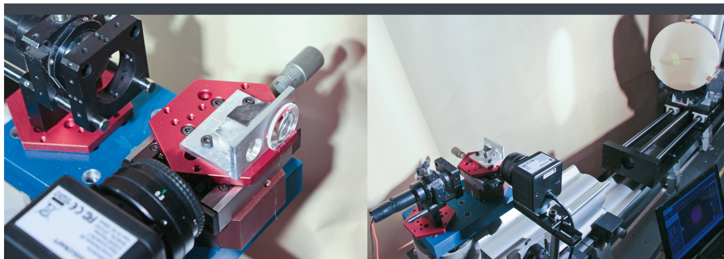
Figure 8: Interféromètre de Bath: tête de mesure (à gauche) et montage complet (à droite).
