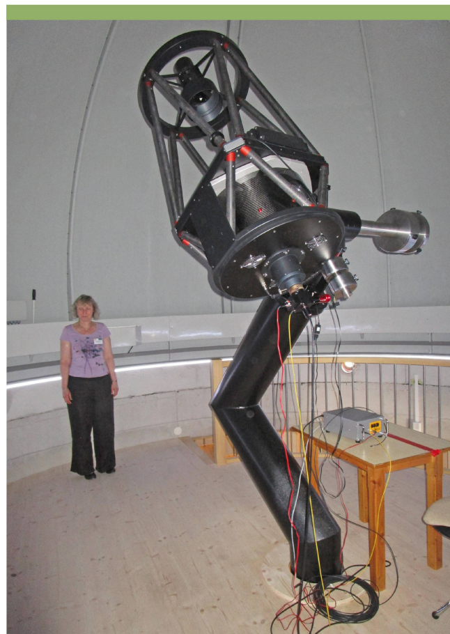
Abbildung 2: Das Hauptinstrument ist das 1-Meter/f7.0-RC-Teleskop von ASA in einer offenen Kuppelkonstruktion.
