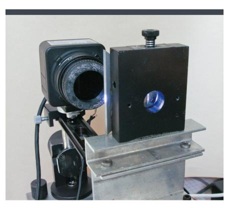
**Figure 4:** Tête de mesure du montage de *Foucault*: la LED d'illumination munie d'une fente est à droite de l'image, le couteau est fixé contre le bloc d'illumination (au centre de l'image). La caméra de mesure est fixée juste derrière.
