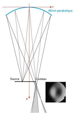
Figure 3: Montage de Foucault: les pinceaux de lumière coupés par le couteau sont représentés en grisé. r pour les deux première images, plus éloigné pour les deux dernières
