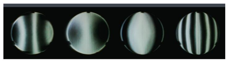
**Figure 2:** Images du miroir observé à travers un réseau de Ronchi de 10 lignes/mm pour diverses positions au voisinage du centre de courbure: plus proche du miroir pour les deux première images, plus éloigné pour les deux dernières.
