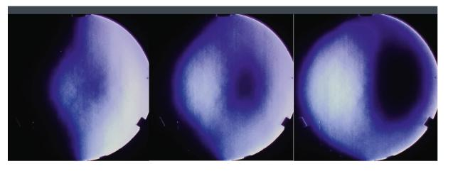
**Figure 6:** Exemples d'images de Foucault pour trois positions du couteau, avec éloignement croissant du couteau par rapport au miroir.
