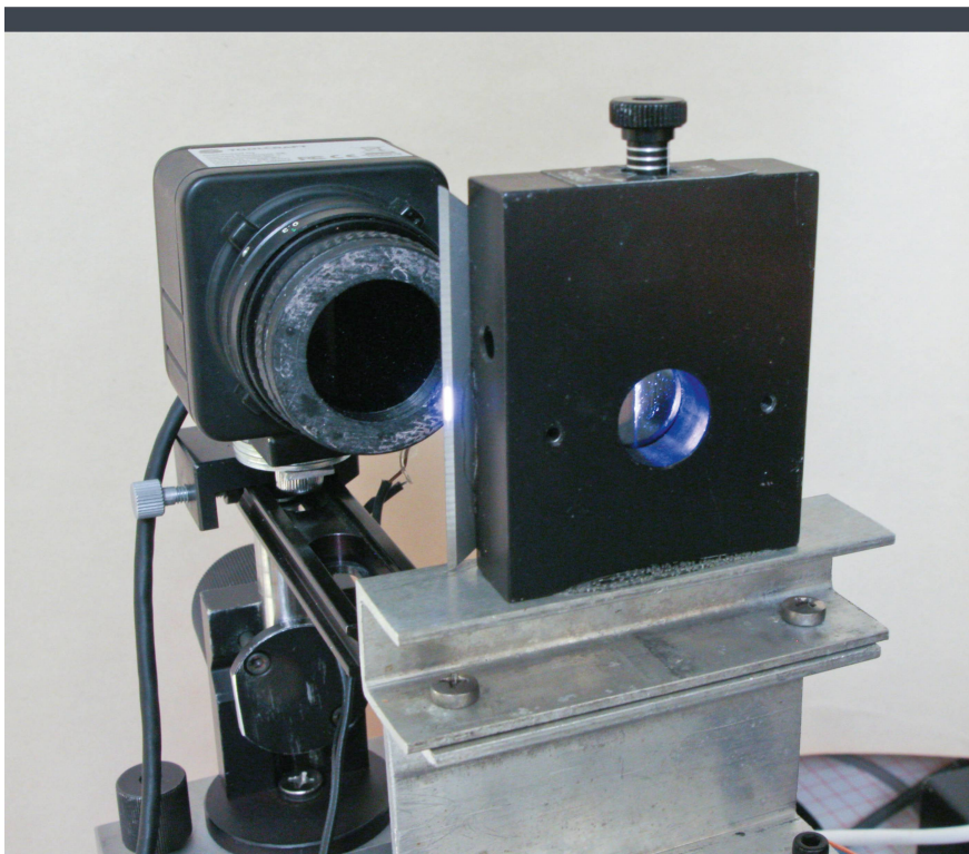
Figure 4: Tête de mesure du montage de Foucault : la LED d'illumination munie d'une fente est à droite de l'image, le couteau est fixé contre le bloc d'illumination (au centre de l'image). La caméra de mesure est fixée juste derrière.
