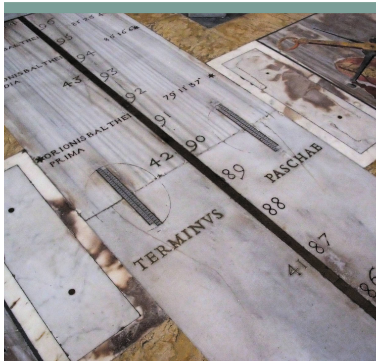
Abbildung 9: An der Stelle der Tagundnachtgleiche ermöglichen die neben der Meridianlinie angebrachten Massstäbe, die Zeitpunkte der Äquinoktien besonders genau zu bestimmen. Die Zahlen rechts von der Meridianlinie bezeichnen wieder die «partes centesimae» während auf der anderen Seite der Linie die dazugehörige Zenitdistanz der Sonne in Grad abzulesen ist. Der Meridiandurchgang erfolgt hier je nach Jahreszeit zwischen 11:53 und 12:24 Uhr MEZ.
