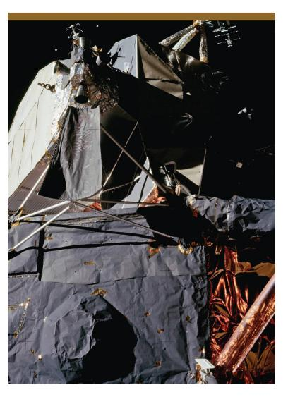
Abbildung 2: Keine Pappe, sondern der Hitze- und Mikrometeoritenschutz, der aus mehreren Schichten Mylar und Aluminium besteht.
