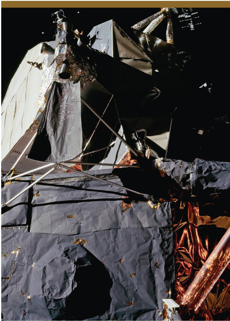
Abbildung 2: Keine Pappe, sondern der Hitze- und Mikrometeoritenschutz, der aus mehreren Schichten Mylar und Aluminium besteht. Aussen ist er mit schwarzer Pyromark-Farbe angestrichen, da Schwarz die Wärme besonders gut absorbiert. Dass es verknittert aussieht, ist Absicht: Damit werden die Kontaktstellen zur Fähre auf ein Minimum reduziert.
