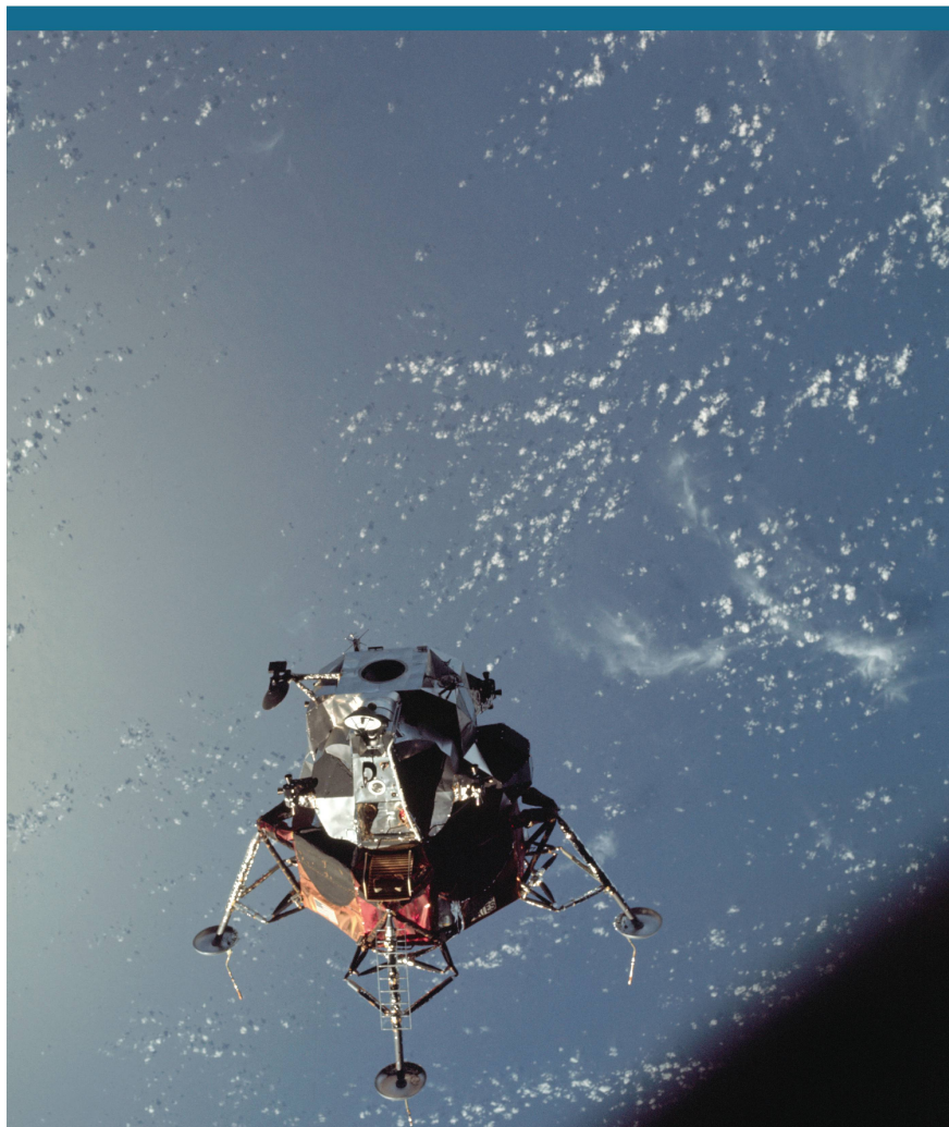
Abbildung 1: Eine Ansicht des Apollo 9 Lunar Modules (LM) «Spider» in der Mondlandekonfiguration, aufgenommen vom Command and Service Modules (CSM) am fünften Tag der Apollo 9-Orbitalmission.
