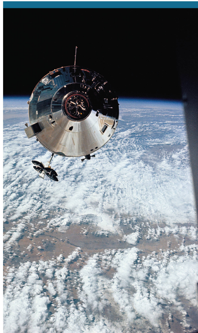
Abbildung 2: Das Command / Service Module von Apollo 9 von der Mondlandefähre aus betrachtet über New Mexico. Der Andockmechanismus ist in der Nase des Befehlsmoduls «Gumdrop» sichtbar.
