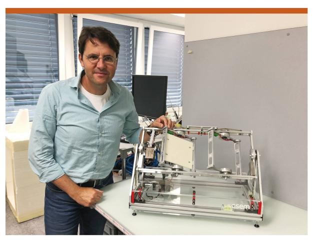
**Abbildung 3:** *Marcel Egli* auf der Erde neben der Random Positioning Machine, mit der die Effekte der Schwerelosigkeit studiert werden können.
