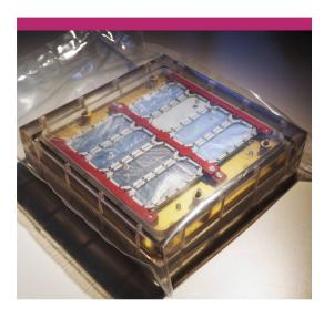
Abbildung 2: Die originalen Folien der Universität Bern, die auf der Raumstation Skylab waren, sind für die Auswertungen in kleine Metallrahmen gespannt worden. Sie sind nach wie vor in einen Plastikbeutel eingeschweisst, um eine Kontamination zu vermeiden.
