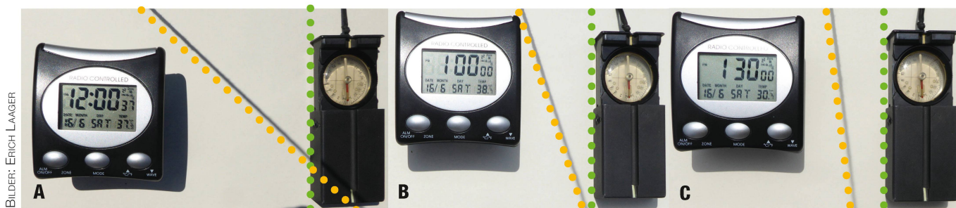
Abbildung 2: Auf einer waagrechten Fläche erkennt man den Schatten eines Lotes (Schnur mit angehängtem Stein), eine funktgesteuerte Digitaluhr und einen Kompass. Es sind jeweils die beiden wichtigen Richtungen zur Sonne (orange) und die Südrichtung gemäss Kompass (grün) eingezeichnet. Aufnahmen vom 16. Juni 2018 in Schwarzenburg um 12:00 Uhr, 13:00 Uhr und 13:30 Uhr MESZ. Man beachte die starke Veränderung des Sonnenstandes (Azimut).
