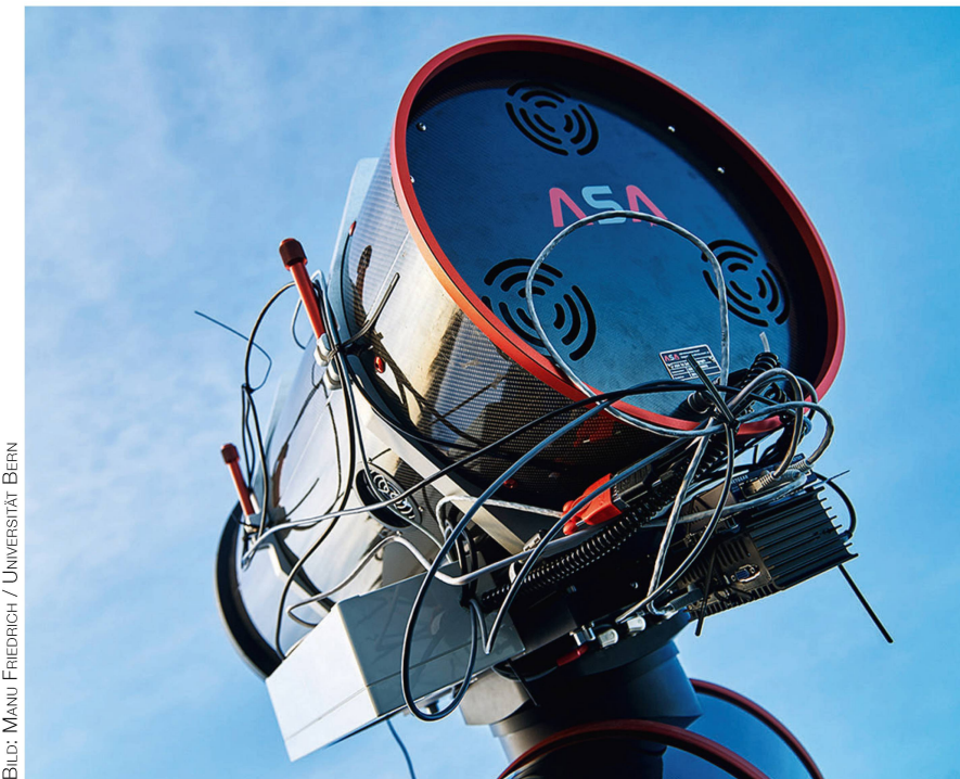
Abbildung 1: Teil des neuen 2 x 40 cm-Zwillingsteleskops, mit dem der Himmel nach Weltraumschrott abgesucht werden kann.
