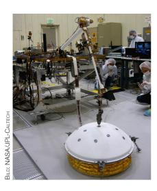
Abbildung 3: Am 4. März 2015 wurde das Seismometer SEIS vom Roboterarm von InSight in einem Testlauf auf den Boden abgesetzt.
