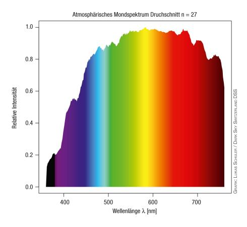
Abbildung 2: Das durchschnittliche Spektrum aus 27 Messungen. Die berechnete korrigierte Farbtemperatur beträgt  $4'663 \pm 5$  Kelvin (unkorrigierte Messung mit Borg ED100 Linse,  $4'605 \pm 5$  Kelvin).
