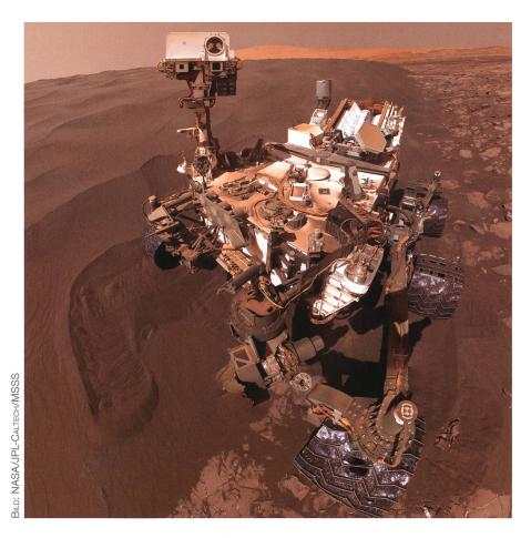
Abbildung 1: «Curiosity» am Rand der «Namib-Düne» (Teil der «Bagnold-Dünen). Die rund 12 km Fahrt haben ihre Spuren hinterlassen. Gut zu sehen ist der Verschleiss, die Verformungen und die Ausbruchstellen an den Reifen des Rovers.
