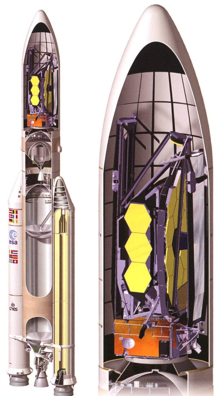
Abbildung 6: Das James Webb-Teleskop, respektive der Hauptspiegel, müssen für den Transport in der Ariane-5-Rakete zusammengefaltet werden und in der Zeit, solange es auf dem Weg zum Beobachtungsort ist, in vielen Teilschritten wieder entfaltet werden.
