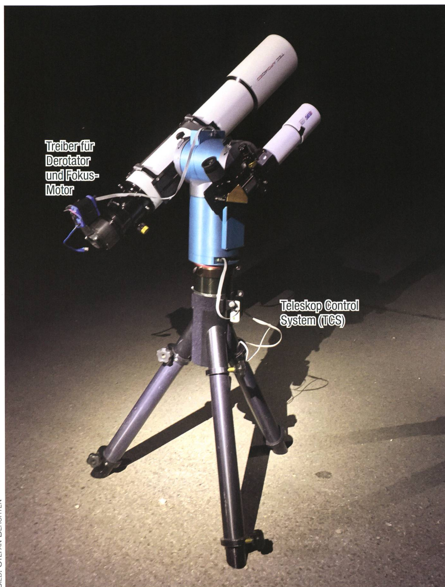
Abbildung 1: Die azimutale Montierung von AOK-Swiss, hier im mobilen Einsatz, ist etwa 30 kg schwer.
