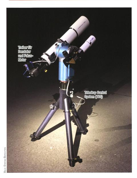
Abbildung 1: Die azimutale Montierung von AOK-Swiss, hier im mobilen Einsatz, ist etwa 30 kg schwer.
