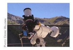
Photo 5: Lunette Lunt de 60mm montée sur une monture équatoriale Sky Watcher HEQ5 Pro, équipement permettant d'observer le Soleil en lumière monochromatique, dévoilant protubérances et autres structures.
