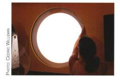
Photo 7 : L'image en lumière blanche (photosphère) obtenue grâce au cœlostat sur l'écran.
