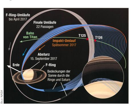
Abbildung 2: Die letzten 22 Umläufe verlaufen zwischen Saturn und seinen Ringen. Im kleinen Ausschnitt rechts sieht man, wie eng die Bahnen über Saturns Atmosphäre verlaufen.
